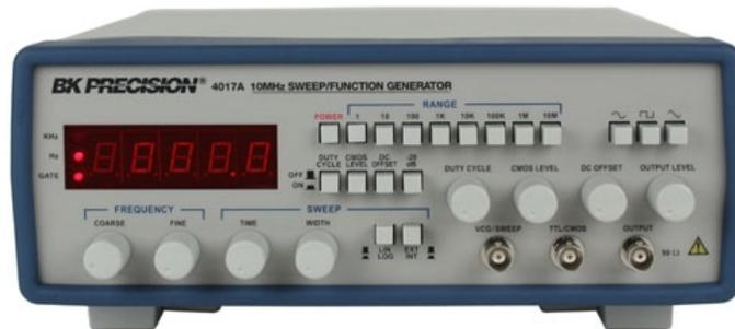
Figura 2. Generador de señales
