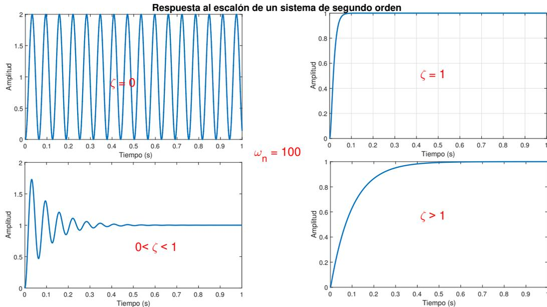
Figura 21. Respuesta de un sistema de 2<sup>do</sup> orden
