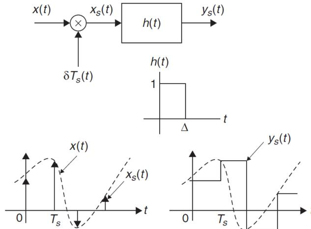
Figura 33. Muestreo utilizando un sistema de muestreo y retención
