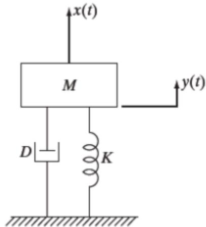
Figura 39. Masa-resorte-amortiguador
