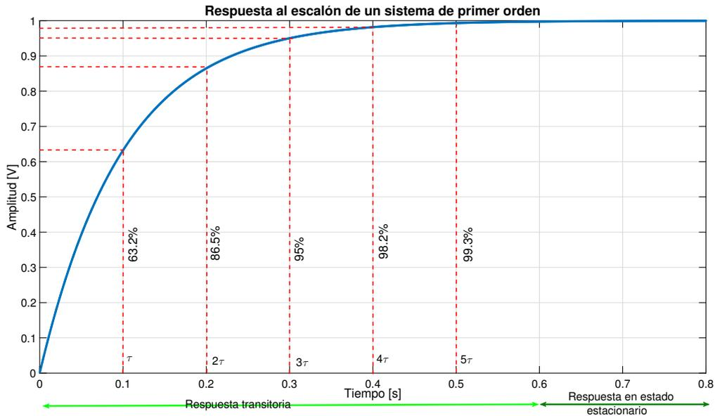
Figura 20. Respuesta de un sistema de 1<sup>er</sup> orden
