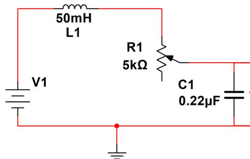
Figura 25. Sistema eléctrico de segundo orden
