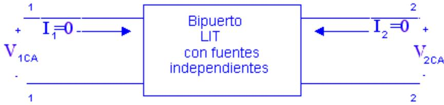
Figura 2  $V_{1CA}$  y  $V_{2CA}$  se determinan haciendo  $I_1 = I_2 = 0$ .
