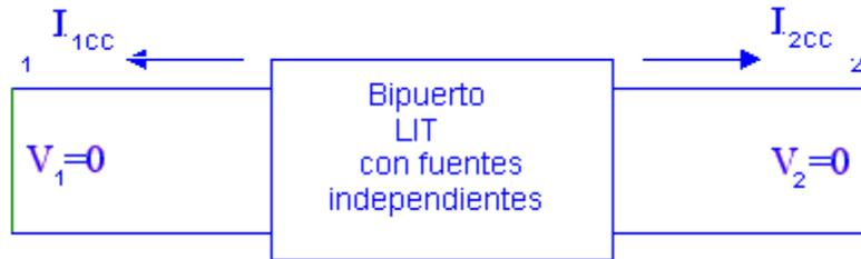
Figura 6 Las corrientes  $I_{1CC}$  e  $I_{2CC}$  se determinan haciendo  $V_1 = V_2 = 0$ .
