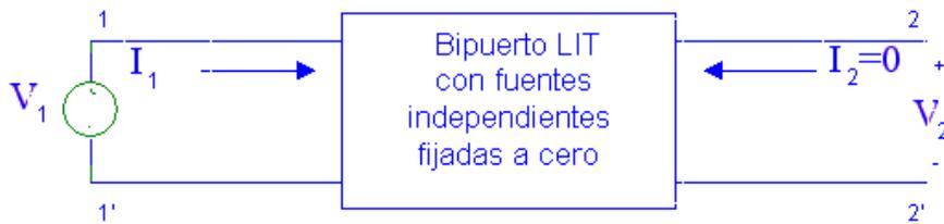
Figura 3 Los parámetros  $z_{11}$  y  $z_{21}$  se determinan haciendo cero  $I_2$  y todas las fuentes independientes internas.
