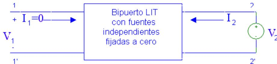
Figura 4 Los parámetros  $z_{12}$  y  $z_{22}$  se determinan haciendo cero  $I_1$  y todas las fuentes independientes internas.
