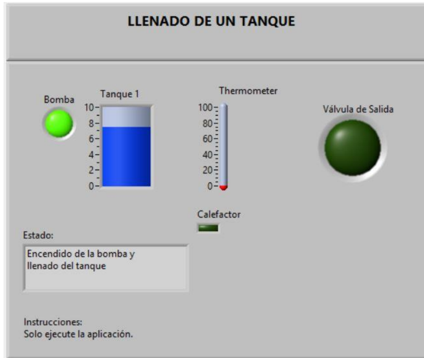
Figura 2. Panel frontal del diagrama de la figura 1.
