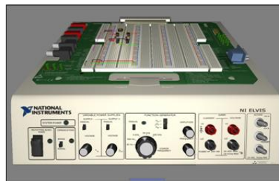
Módulo y Tarjeta Prototipo NI ELVIS y software instalado NI ELVIS 2.0 que incluye: Fuente de voltaje, Generador de funciones, Osciloscopio, Tableta de conexiones.
