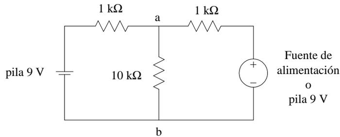
Figura III.1. Circuito lineal para comprobar el teorema de superposición.
