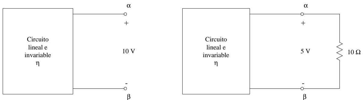
Figura IV.8. Circuito lineal e invariante en el tiempo.
