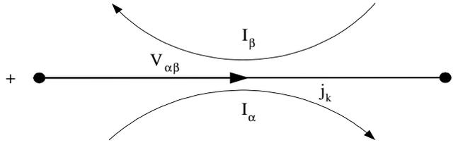
Figura II.1. Una rama arbitraria k, común a las mallas  $\alpha$  y  $\beta$ .
