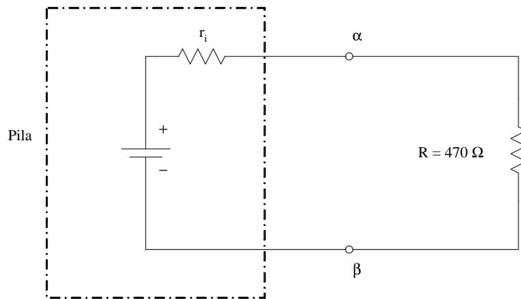
Figura IV.6. Circuito para calcular el circuito equivalente de Thévenin de una pila.
