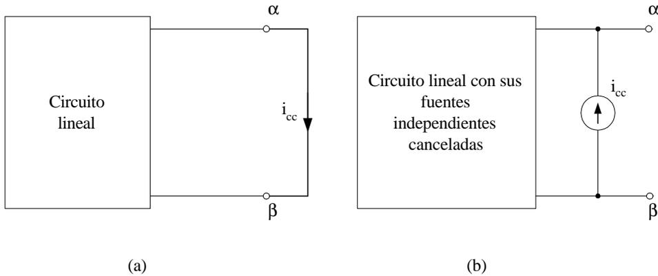
Figura IV.3. (a) Circuito lineal. (b) Su circuito equivalente de Norton
