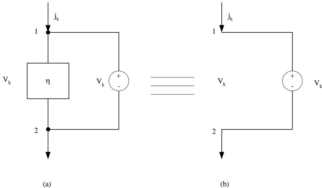
Figura I.2. (a) Fuente ideal de voltaje en paralelo con un circuito  $\eta$ . (b) Circuito equivalente.
