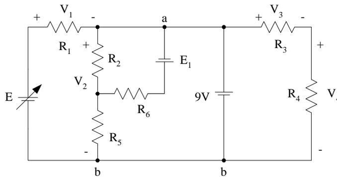
Figura I.4. Circuito para comprobar el teorema de sustitución.
