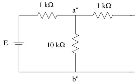
Figura III.3. Circuito de la Fig. III.1 con una fuente de voltaje cancelada.
