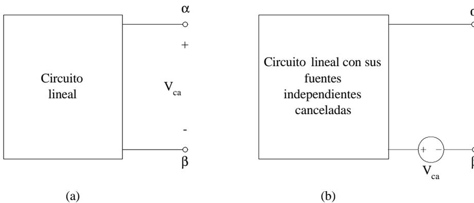
Figura IV.2. (a) Circuito lineal. (b) Su circuito equivalente de Thévenin.
