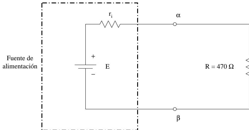
Figura IV.7. Circuito para calcular el circuito equivalente de Thévenin de la fuente de alimentación.
