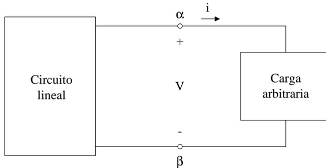
Figura IV.1. Circuito lineal con una carga arbitraria.
