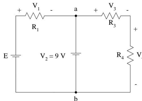
Figura I.5. Circuito en el que se ha aplicado el teorema de sustitución.
