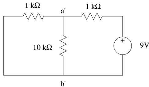
Figura III.2. Circuito de la figura III.1 con una fuente de voltaje cancelada.
