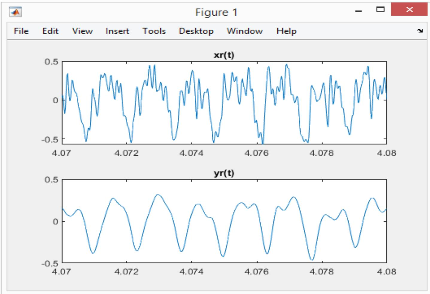
Señal de audio  $x_r(t)$  transformada en la señal de audio  $y_r(t)$  de forma discreta, utilizando un sistema FIR con  $F_s = 44100[\text{Hz}]$
