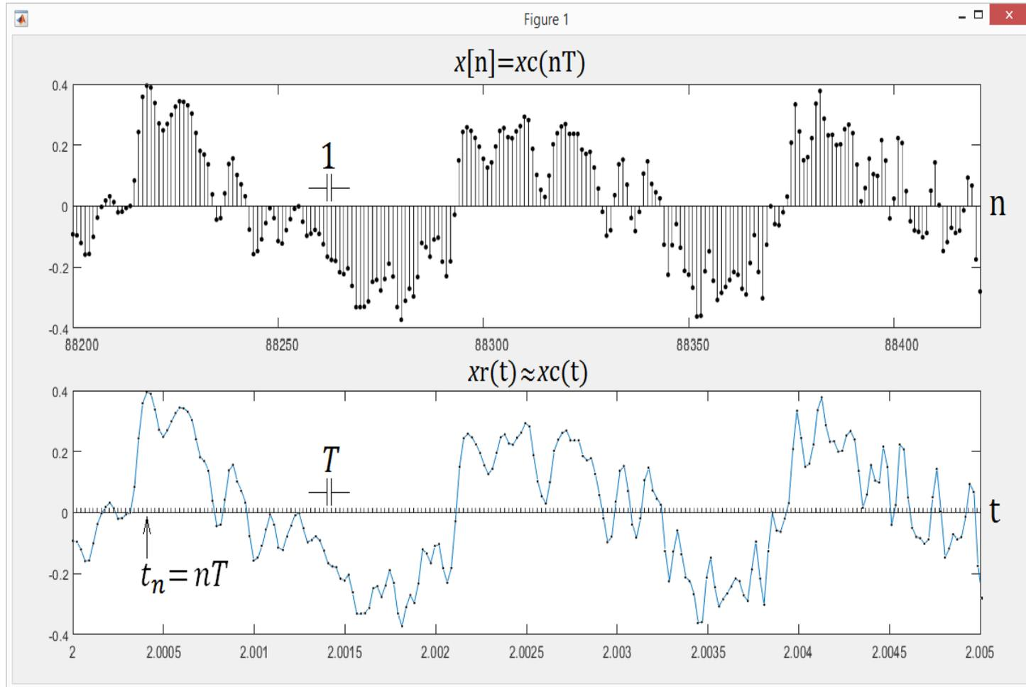
5ms de una señal de audio con  $F_{max} = 20\text{kHz}$  y  $F_s = 44.1\text{kHz}$
