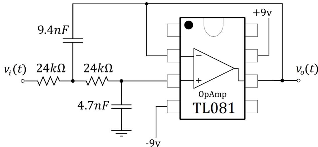
El circuito eléctrico mostrado en la figura anterior implementa un sistema LTI continuo (filtro paso-bajas Butterworth de orden 2 con frec. de corte  $F_c = 1000[\text{Hz}]$ ) con función de transferencia:
