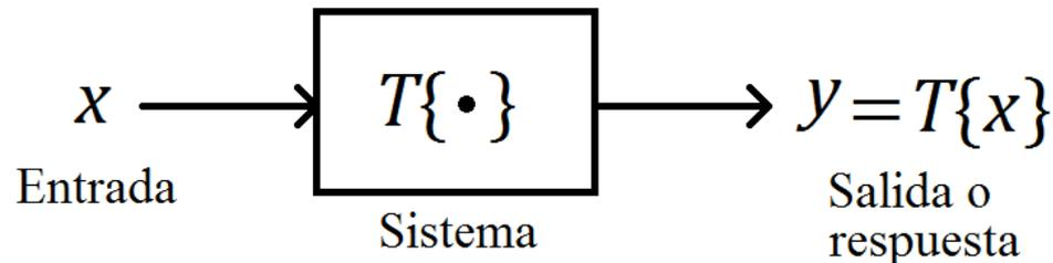
Figura. Representación entrada-salida de un sistema  $T$ .
