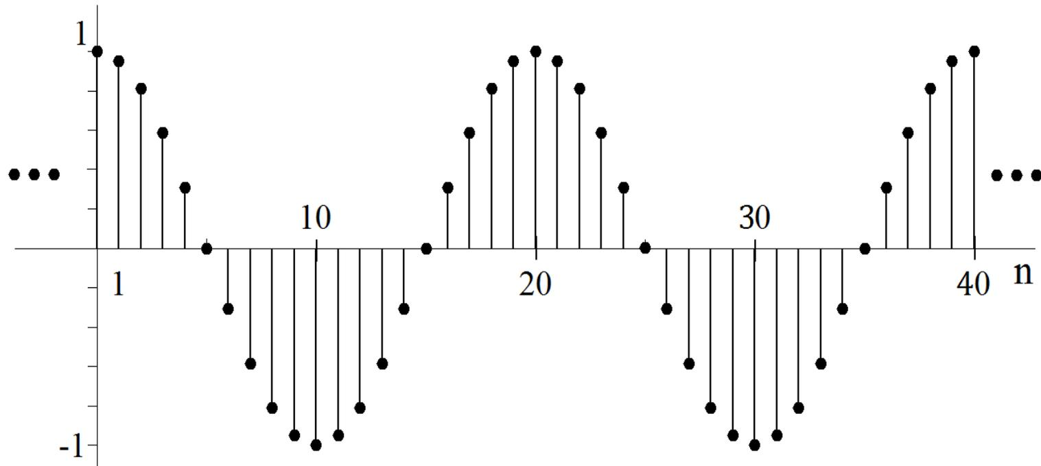
En este caso  $F_{max} = 500$  [Hz] y  $F_s = 10000$  [Hz]. Como  $F_s > 2F_{max}$ , de acuerdo con teorema de muestreo,  $x_c(t)$  puede ser reconstruido exactamente a partir de su secuencia de muestras  $x[n]$ .
