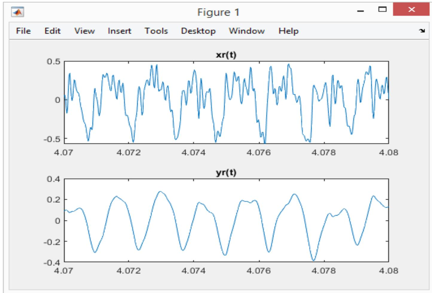
Señal de audio  $x_r(t)$  transformada en la señal de audio  $y_r(t)$  de forma discreta, utilizando un sistema IIR con  $F_s = 44100[\text{Hz}]$
