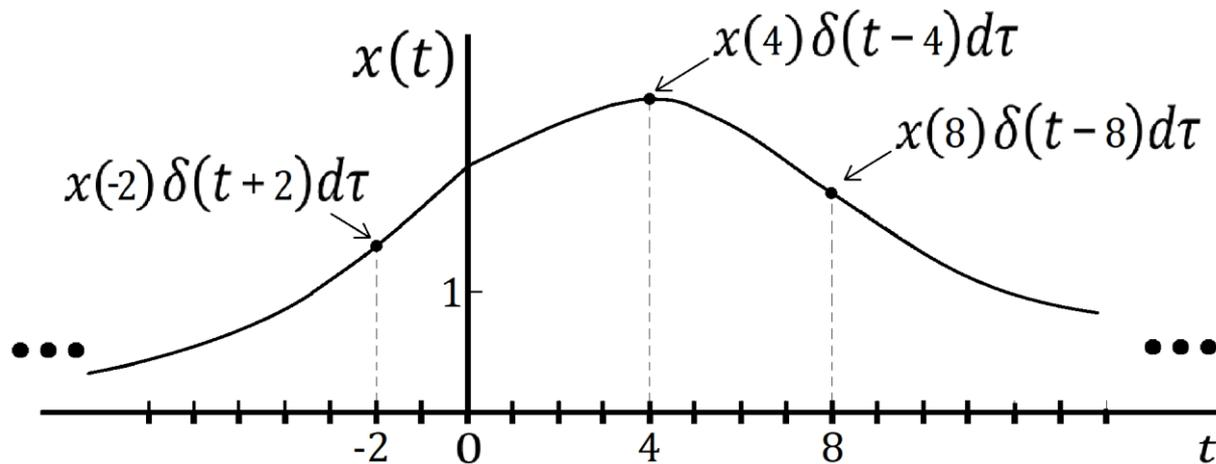
Sea un sistema continuo LTI con regla de correspondencia  $T\{\cdot\}$ , y con respuesta al impulso  $h(t) = T\{\delta(t)\}$ . La respuesta del sistema  $T$  a una señal  $x(t)$  cualquiera está dada por:
