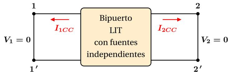
**Figura 1.5:** Las corrientes  $I_{1CC}$  e  $I_{2CC}$  se determinan haciendo  $V_1 = V_2 = 0$ .
