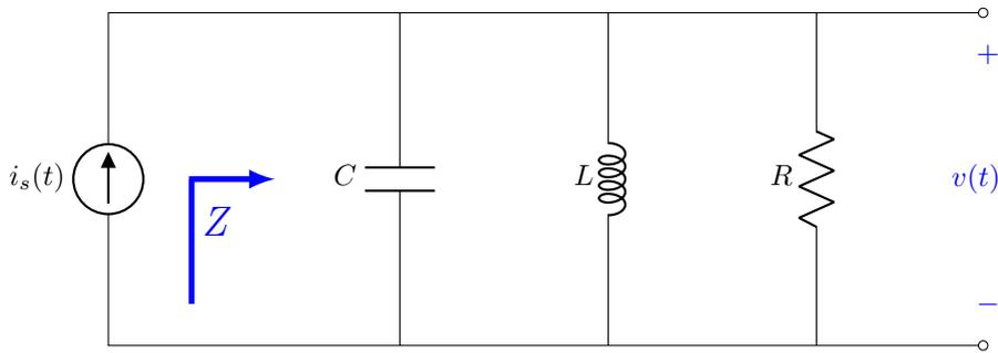
Figura 6.3. Circuito eléctrico RLC paralelo resonante básico.
