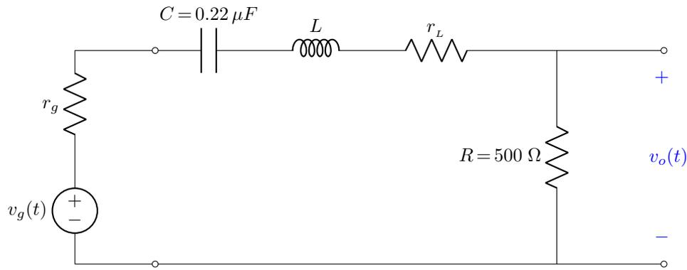
Figura 6.5. Circuito eléctrico resonante RLC serie.
