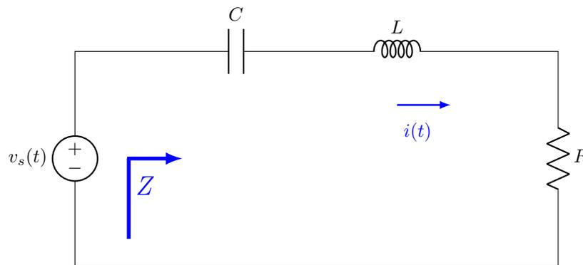
Figura 6.1. Circuito eléctrico RLC serie resonante básico.
