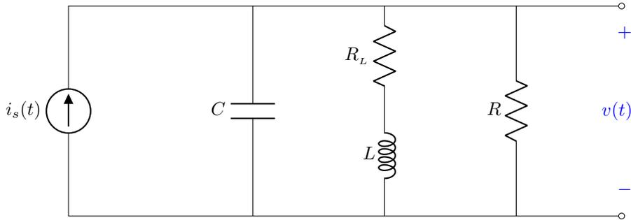
Figura 6.4. Circuito eléctrico RLC paralelo resonante real.
