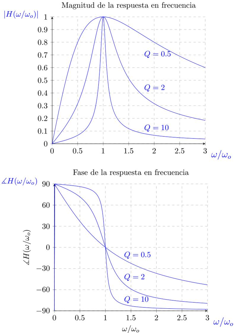
Figura 6.2. Respuesta en frecuencia del circuito RLC serie.
