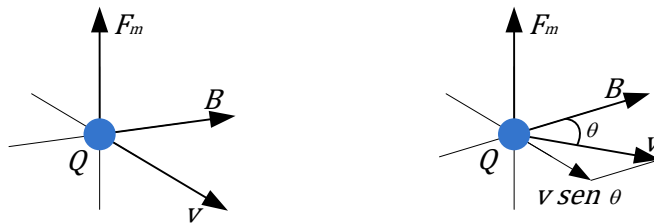
Figura 4.6. Una carga eléctrica móvil donde hay un campo magnético, sufre una fuerza.
