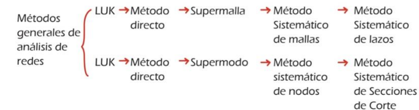
Figura 1. Clasificación de los métodos generales de análisis de redes eléctricas
