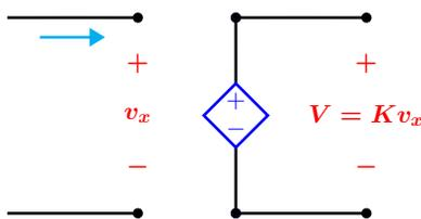
Figura 1.20: Fuente de Voltaje controlada por voltaje.
