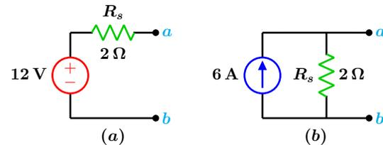
Figura 1.36: Circuitos equivalentes.
