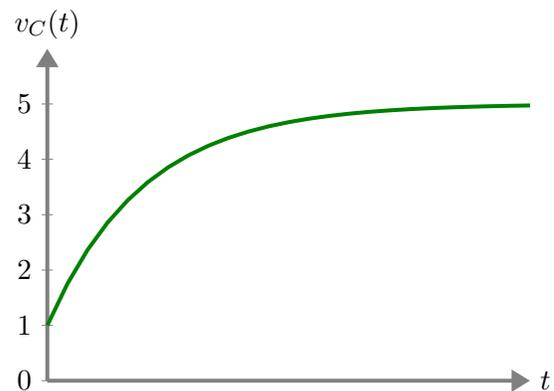
Figura 1.66: Respuesta transitoria y permanente del circuito RC
