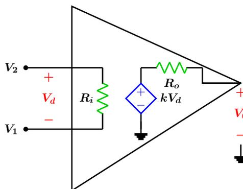
Figura 1.25: Modelo simple de un Amplificador operacional.
