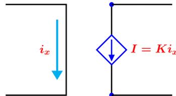
Figura 1.21: Fuente de corriente controlada por corriente.
