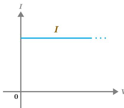
Figura 1.17: Relación corriente-voltaje. La corriente es constante.
