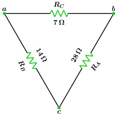
Figura 1.44: Configuración delta.
