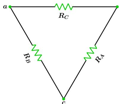
Figura 1.40: Configuración delta.
