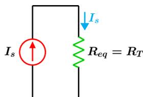
Figura 1.32 b: Circuito equivalente
