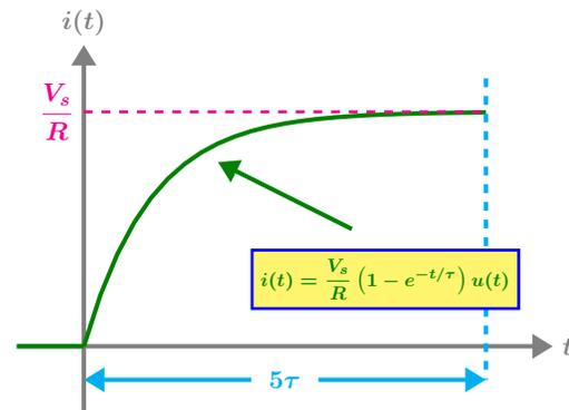
Figura 1.53: Respuesta transitoria y permanente del circuito RL
