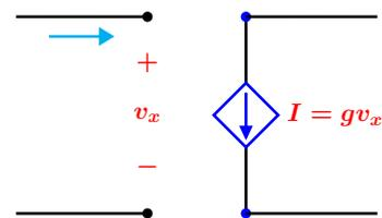
Figura 1.23: Fuente de corriente controlada por voltaje.
