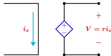
Figura 1.22: Fuente de Voltaje controlada por corriente.
