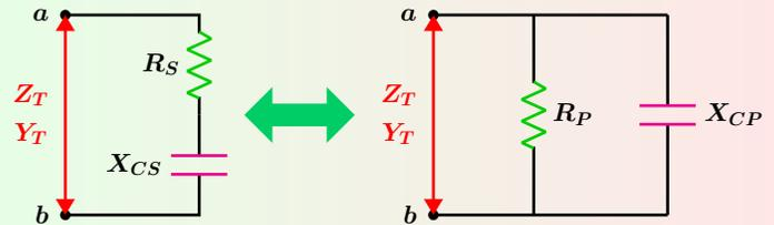
Figura 19: Circuitos equivalentes.
