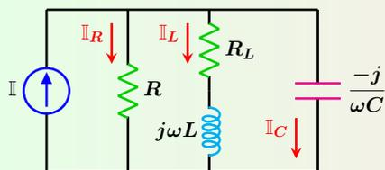
**Figura 15:** Circuito resonante.
