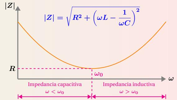
**Figura 5:**  $|Z|$  en función de la frecuencia  $\omega$ .
