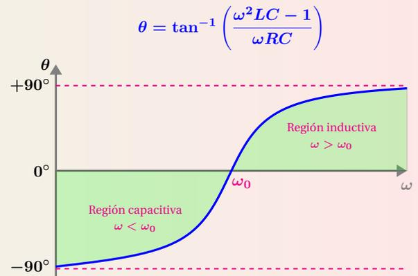
**Figura 6:**  $\theta$  en función de la frecuencia  $\omega$ .
