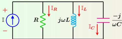
**Figura 14:** Circuito Resonante.
