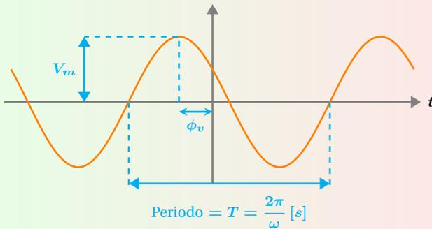
**Figura 1:** Amplitud  $V_m$ , periodo  $T$  y fase  $\phi$ .
