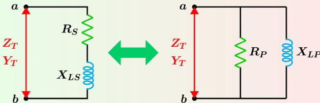
Figura 18: Circuitos equivalentes.
